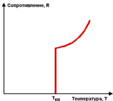
Рис. 38. Зависимость сопротивления материала (металла или керамики) от температуры
